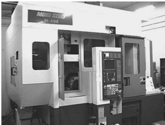
図3 5軸制御マシニングセンタの外観図
