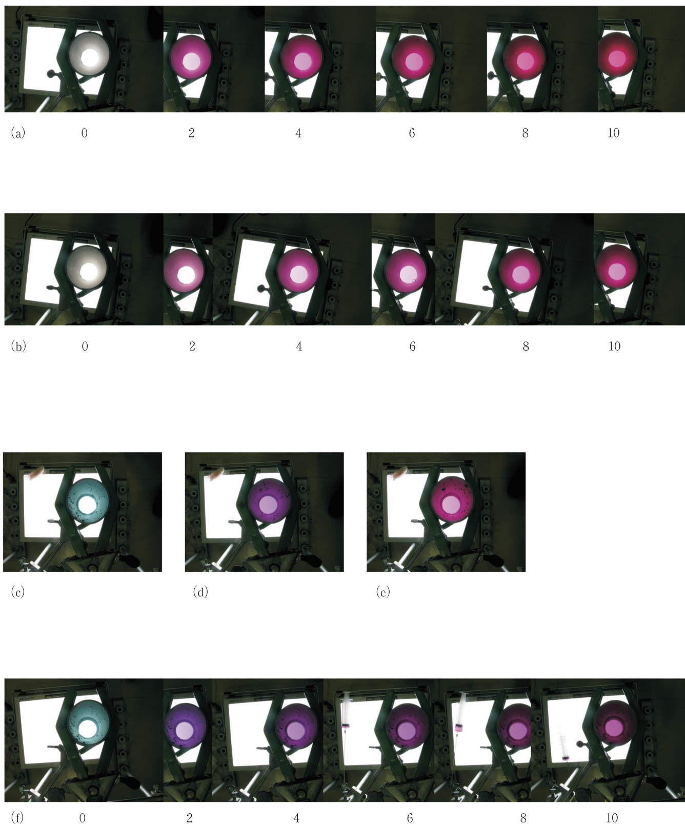
図4 つり合い比色計における溶液の色調。図中の数値は溶液中光路長を示す(単位cm)。(a) 発色させた0.5ppm亜硝酸溶液, (b) 発色させた0.25ppm亜硝酸溶液, (c) 擬似試料溶液の水深8cmでの色調, (d) 発色擬似試料溶液の水深8cmでの色調, (e) 亜硝酸0.25ppm溶液の水深8cmでの色調, (f) 内筒に擬似試料溶液を水深8cmになるように入れ, 外筒に発色させた亜硝酸0.5ppm溶液を入れ, その水深を0から10cmの範囲で変化させた際の溶液の色調。
