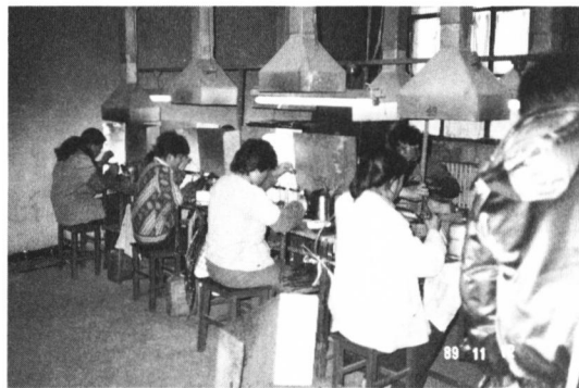
写真3. 梨園郷工芸美術品福祉廠 (バーナーでガラスの花卉・葉を作る工程)
