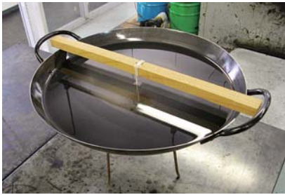
図10 溶解したロウを固める様子
