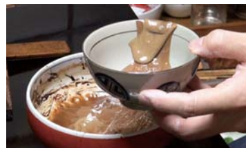
図14 「地固め」に用いる生漆
