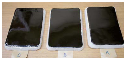
図9 漆が塗布されたテストピース
