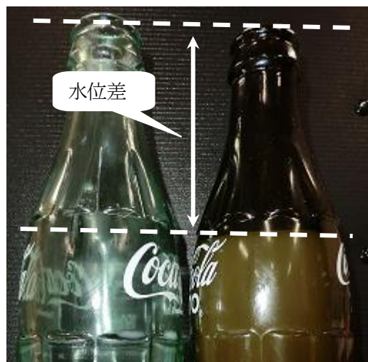
図2 コーラ瓶からコーラ Zero 瓶へ水を移す 水面の高さは同じ位置にある。しかし、C_R 瓶に満水の水をC_0瓶に移すと水位が下がる（図2）。これは、左右の瓶のガラスの厚
