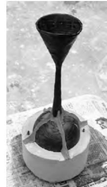
図24（石膏鑄型の半分と湯口を成形）
