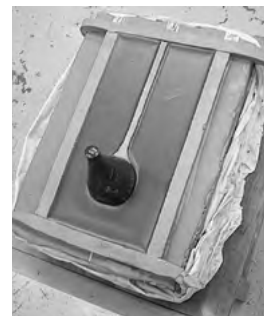
図8 (液状の蠟を流し込む)
