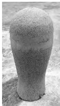
図25（石膏鑄型の成形）
