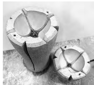
図27（内部の木を取り出し、石膏鑄型を焼成）
