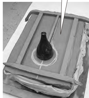
図7 (粘土の堰を設ける)
