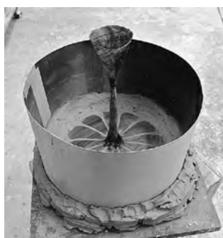
図30 (湯道の接続, 鑄型材を流し込むための囲い)
