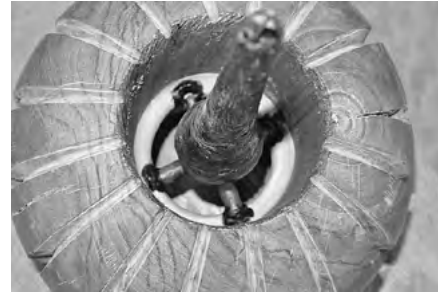
図13 (蠟の造形を取り付ける)
