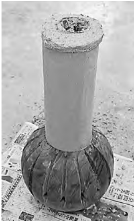
図14 (木に石膏鑄型を挿入)
