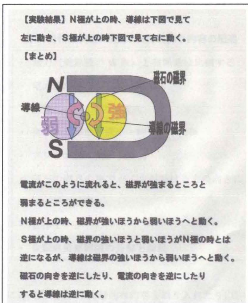
図5 磁石の磁界の中で電流を流したコイルが受ける力についての自作教科書
