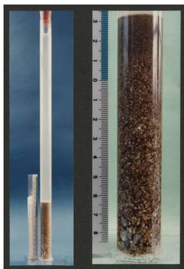
図 3-18 長さ約 1 m のアクリルパイプの底部に形成された正級化層．右はその拡大．
