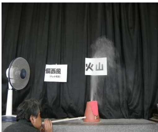
図 3-17 『麩』を用いた火山灰の堆積モデル実験
