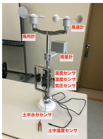
図 3-2 試作した水田気象観測装置
